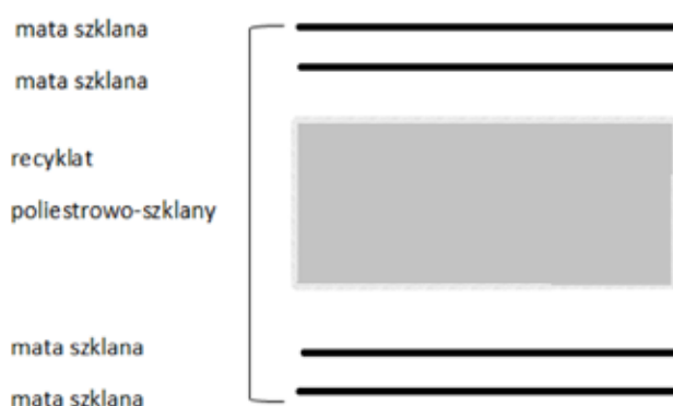
Rys. 1. Schematyczne przedstawienie ułożenia wzmocnienia w laminatach z recyklatem poliestrowo-szklanym
