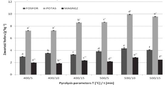
Legend: Fosfor: Phosphorus, Potas: Potassium, Magnez: Magnesium, Zawartość fosforu: The content of phosphorus
