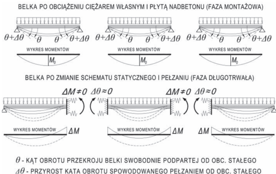
Rys. 2. Mechanizm powstawania wtórnych efektów reologicznych – przyrost odkształceń i kątów obrotu belek wolnopodpartych poddanych pierwotnym efektom pelzania i ich zachowanie się w schematach hiperstatycznych (utwierdzenie podatne)
