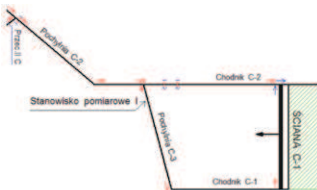
Rys. 7. Schemat rejonu ściany w pobliżu skrzyżowania
