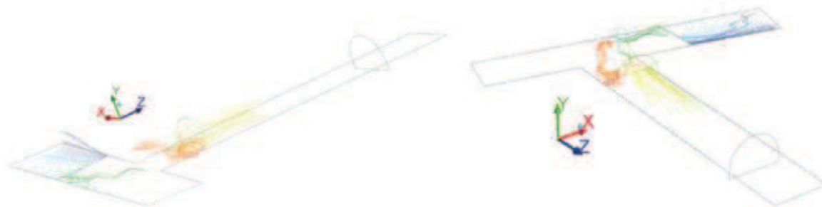
Rys. 14. Linie prądu wypływające z wybranych linii w chodniku C-2 i C-3
