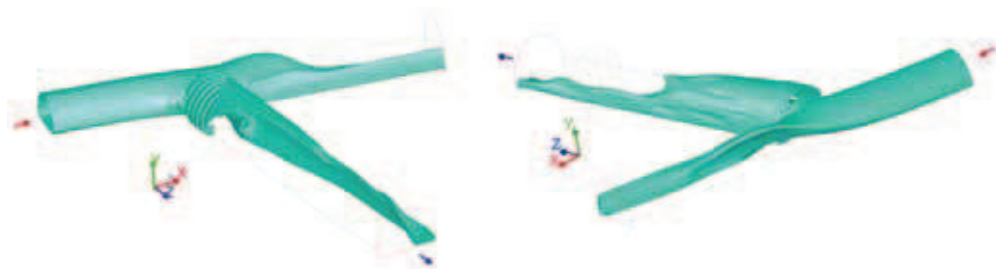
Rys. 9. Przepływ w skrzyżowaniu – widoki powierzchni stałej prędkości 1.8 m/s Fig. 9. Flow in the intersections – view of isosurface for 1.8 m/s velocity
