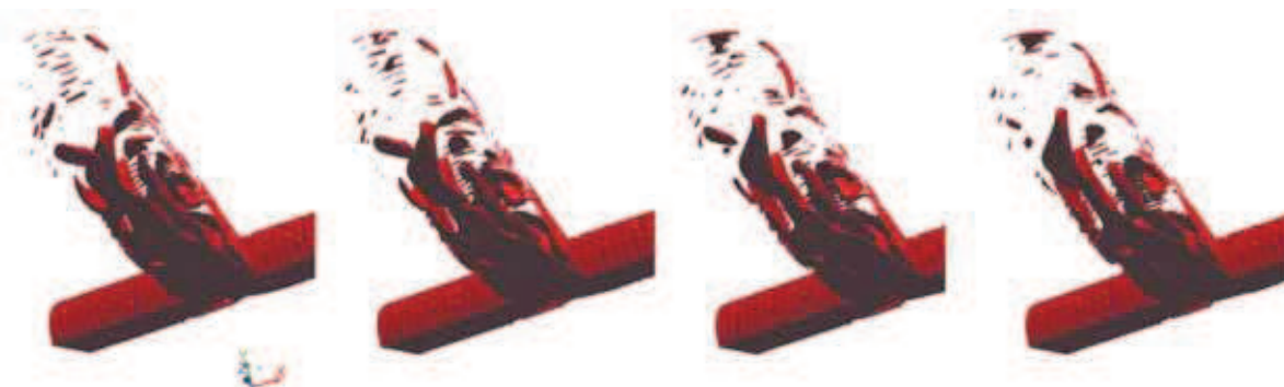
Rys. 18. Powierzchnie stałej prędkości poprzecznej do osi wyrobiska v_{xy} = 0.3 m/s co 1 sekundę symulacji Fig. 18. Isosurface of constant velocity transverse to the axis of sidewalk v_{xy} = 0.3 m/s by measuring every second of simulation
