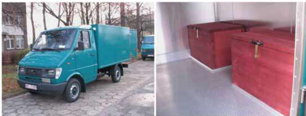
Rys. 1. Samochód dopuszczony do transportu materiałów wybuchowych z widokiem na przedział ładunkowy środków inicjowania (zapalników)
