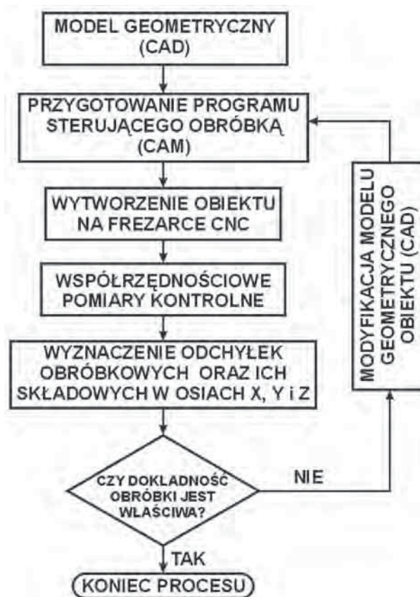
Rys. 1. Metoda off-line korekcji błędów obróbkowych Fig. 1. Method of off-line of machining error correction
