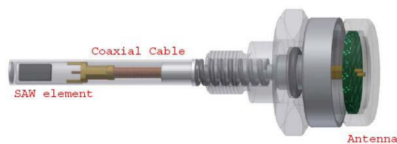
Rys. 3. Widok bezprzewodowego czujnika przeznaczonego do pomiaru temperatury [10]
