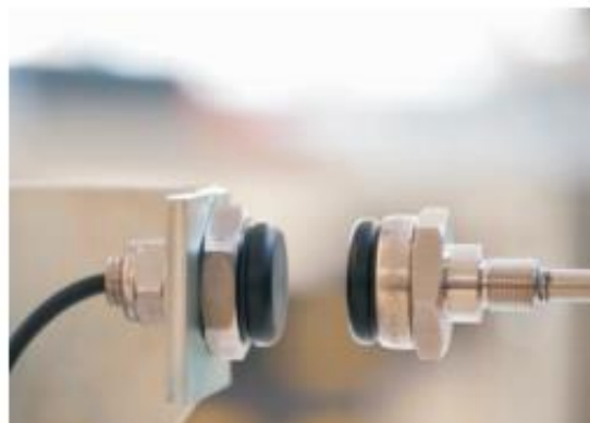
Rys. 5. Widok bezprzewodowego czujnika i stacjonarnej anteny do pomiaru temperatury. [10]
