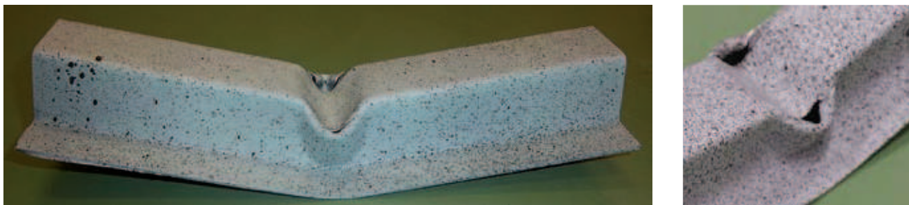
Rys. 3. Eksperyment laboratoryjny. Próbki po odkształceniu: a) cała próbka, b) miejsce przyłożenia obciążenia
