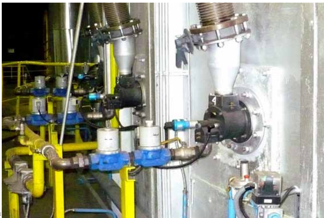
Rys. 3. System grzewczy pieca z obrotowym trzonem o średnicy podziałowej 13,5 m po modernizacji Fig.3. Heating system of carousel furnace: effective diameter 13,5 m after modernization
