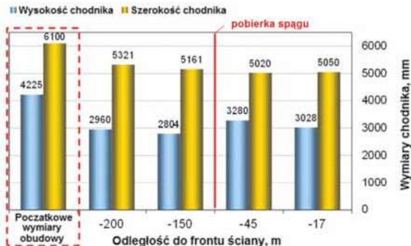
Rys. 4. Rezultaty pomiarów deformacji chodnika C-4 Fig. 4. Results of gateroad C-4 deformation measurements
