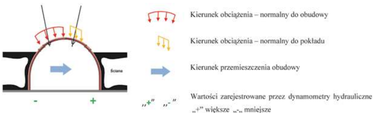
Rys. 8. Mechanizm deformacji chodnika C-4 Fig. 8. Mechanisms of gateroad C-4 deformations
