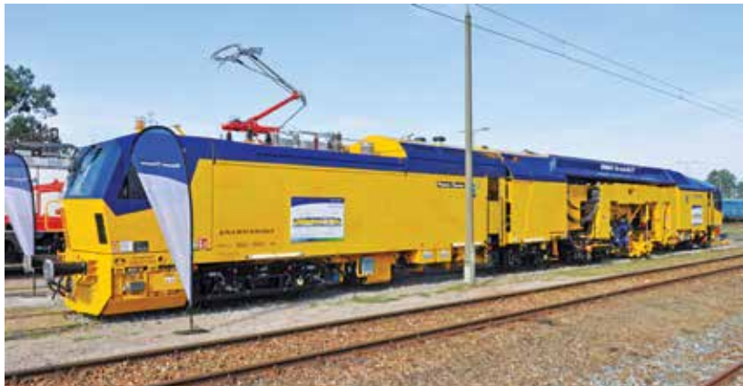
Podbijkarka torowa Unimat 09-4x4/4S E3 Dynamic (producent – Plasser und Thuerer), obecnie własność firmy Torpol
