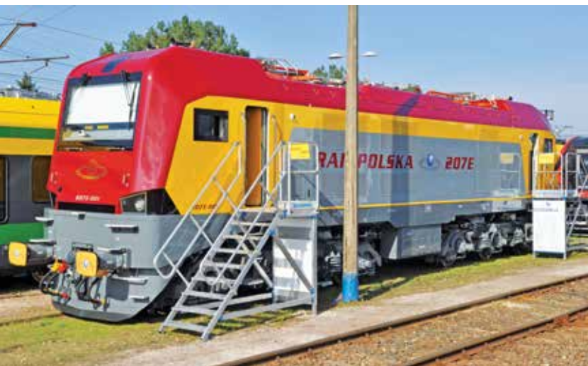
Lokomotywa elektryczna typu 207E-001 (3 kV DC) przewoźnika Rail Polska, powstała przez głęboką modernizację M62
