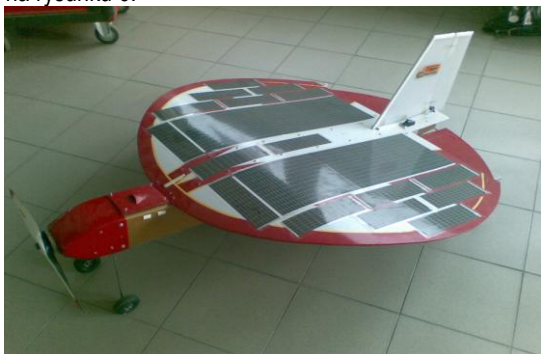
Rys. 6. Bezzałogowy aparat latający zasilany ogniwami fotowoltaicznymi [źródło własne]
