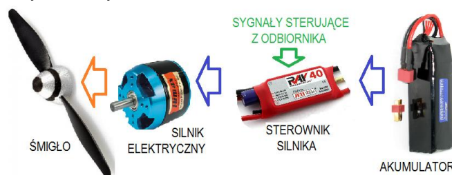
Rys. 3. Schemat lotniczego zespołu napędowego z silnikiem elektrycznym [źródło własne]
