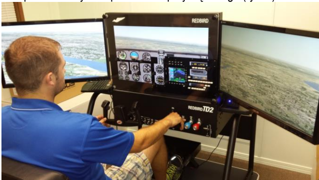
Rys. 5. Symulator lotniczy BITD [20]
