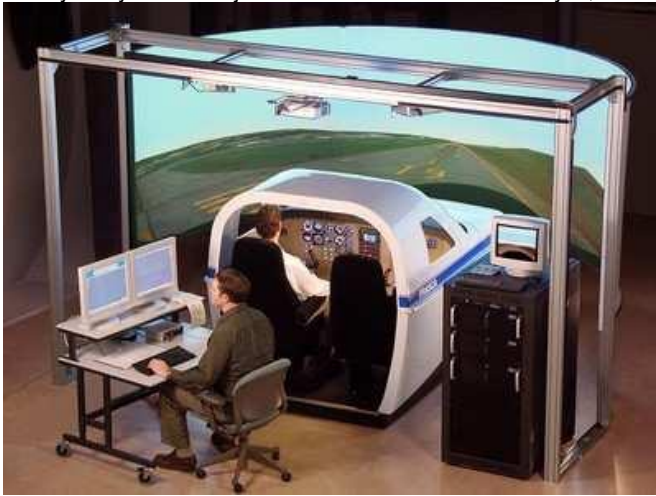
Rys. 3. Symulator lotniczy FTD [18]
