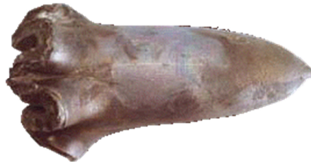
Rys. 6. Pocisk EFP uformowany ze sferycznej wkładki, odzyskany po wybuchu ładunku [4]
