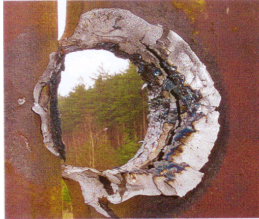
Rys. 2. Widok otworu w płycie RHA grubości 40 mm przebitej pociskiem EFP [1]
