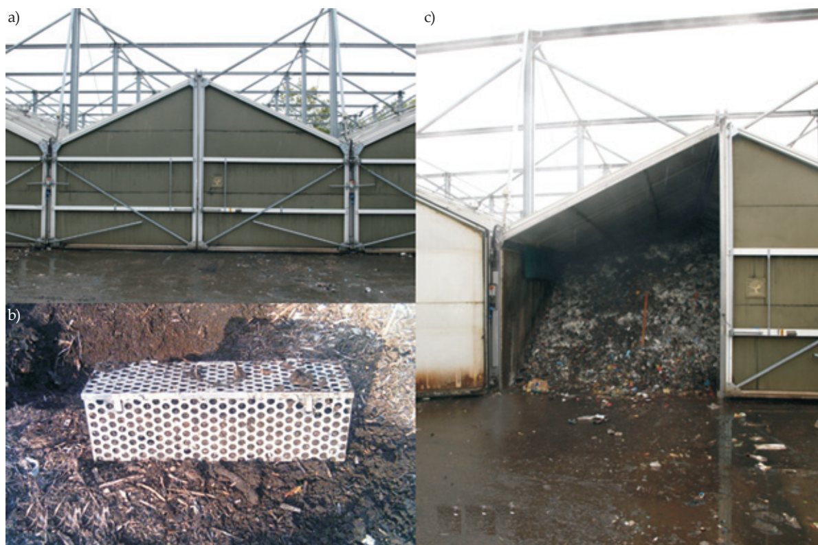
Rys. 2. a) Zadaszone tunele systemu BIODEGMA, b) kosze ze stali nierdzewnej z przygotowanymi próbkami przed degradacją, c) stanowisko badawcze Fig. 2. a) Roofed BIODEGMA system tunnels, b) stainless steel cage with samples before degradation, c) research site
