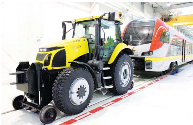
Do przetwarzania taboru zakupione zostały ciągniki szynowo-drogowe. Fot. A. Massel
