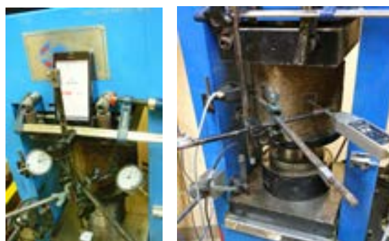
Ryc. 1. Próbka sześcienna cementogruntu w maszynie wytrzymałościowej. Wykorzystanie czujników analogowych (a) i cyfrowych (b) do pomiarów deformacji bocznej
