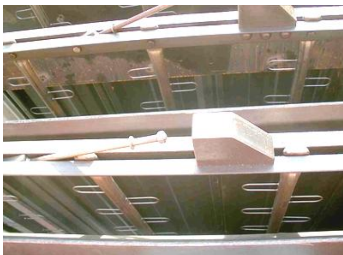
Rys. 2.6. Płaski układ elektrod (elektroda zbiorcza typu SIGMA i elektroda ulotowa typ U) [8]
