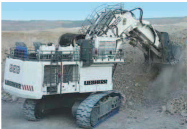
Rys. 1. Urabianie mechaniczne koparką nadsiębierną Liebherr R 996 B [12]
