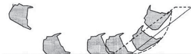
Rys. 6. Proces napełniania łyżki ładowarki [4]
