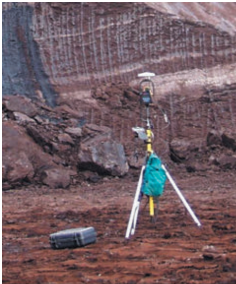
Rys. 4. Zestaw pomiarowy: odbiornik GPS SCA-12 + dalmierz laserowy Fig. 4. Measuring set: SCA-12 GPS receiver + laser rangefinder
