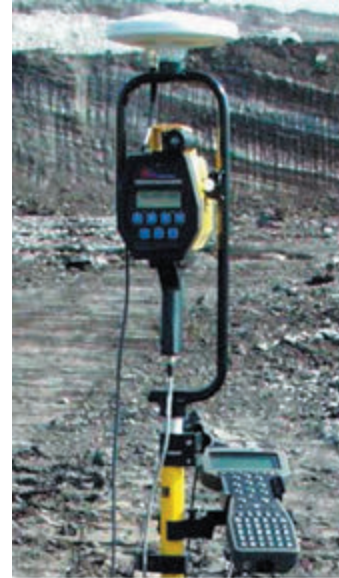
Rys.3. Odbiornik GPS wyznaczający miejsce profilowane - z prawej domiar taśmą mierniczą, tradycyjny sposób profilowania „na oko” Fig. 3. GPS receiver designating a profiled place – on the right traditional way of profiling “on face of it” using a measuring tape
