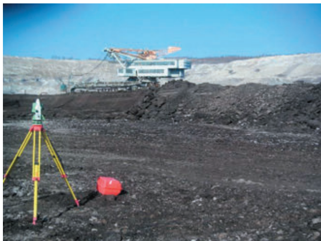
Rys. 6. Tachimetr elektroniczny Leica TS-15 – profilowanie skarp roboczych Fig. 6. LeicaTS-15 Total Station – profiling of the working slopes
