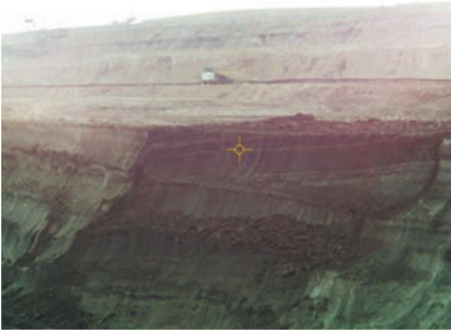
Rys. 8. Zdjęcie wykonane kamerą tachimetru - zaznaczone punkty mierzone Fig. 8. Photo taken with the Leica Total Station (marked measured points)
