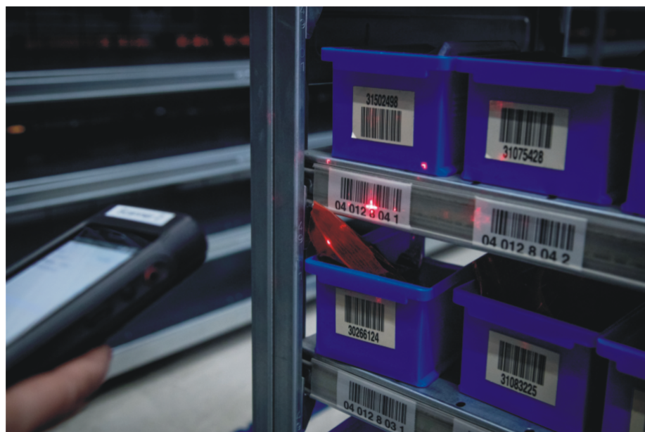
Rys. 5. Pojemniki z towarem i miejsca ich składowania oznakowane kodami
