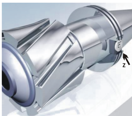
Rys. 3. Frez kształtowy ze znacznikiem (Z) usytuowanym w oprawce narzędziowej
