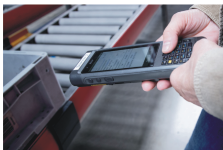
Rys. 13. Mobilny, bezprzewodowy czytnik kodów kreskowych i alfanumerycznych
