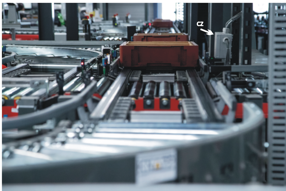
Rys. 14. Stacjonarny czytnik kodów (Cz) w linii transportowej w centrum logistycznym [1]
