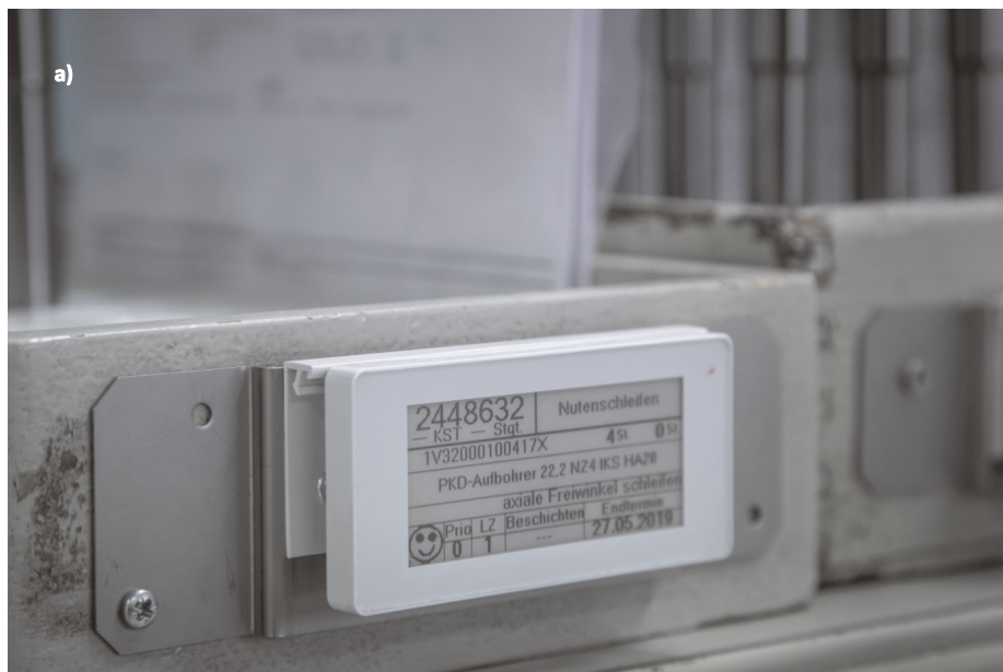
Rys. 1. Przykłady stosowanego oznakowania: a) znakami alfanumerycznymi, b) kodem kreskowym, c) kodem mozaikowym
