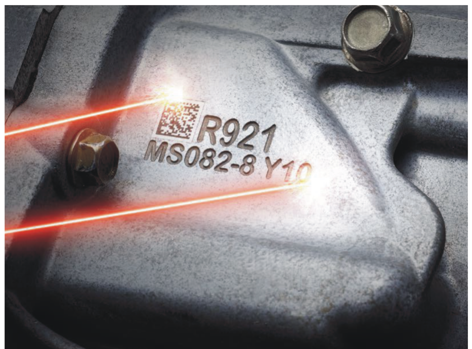
Rys. 10. Element z oznakowaniem alfanumerycznym i mozaikowym wykonanym laserowo [2]
