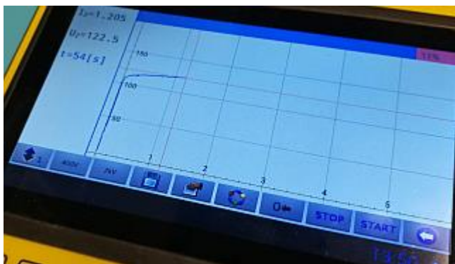
Rys. 7. Wyznaczanie charakterystyki magnesowania rdzenia przekładnika miernikiem MchM-2 [fot. opracowanie własne autorów artykułu]
