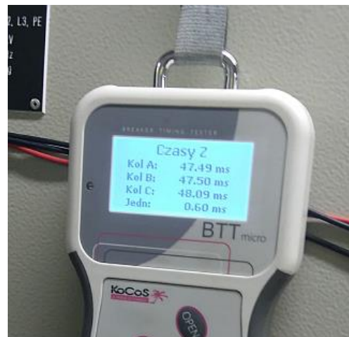
Rys. 4. Wyniki pomiarów niejednoczesności otwierania i zamykania oraz czasów własnych wyłącznika [fot. opracowanie własne autorów artykułu]
