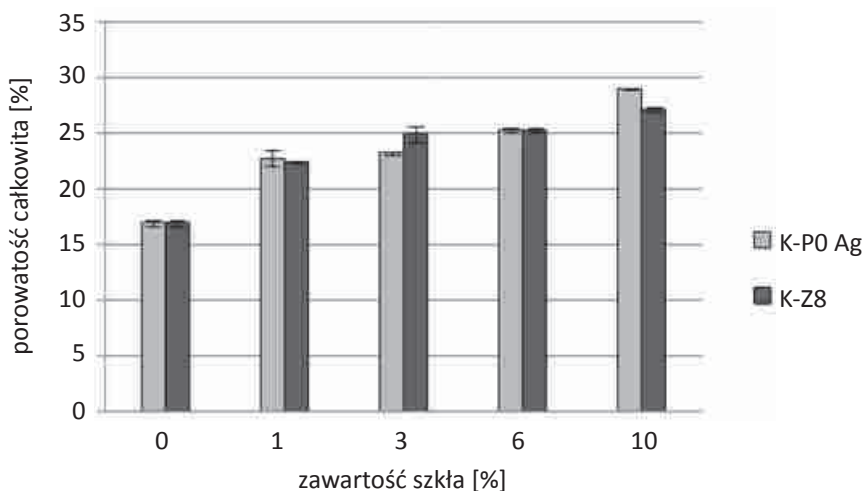
Ryc. 2. Wyniki badania porowatości całkowitej materiałów kalcytowych i materiałów kalcytowych zawierających bioszklę ze srebrem (wartości średnie z odchyleniem standardowym)
