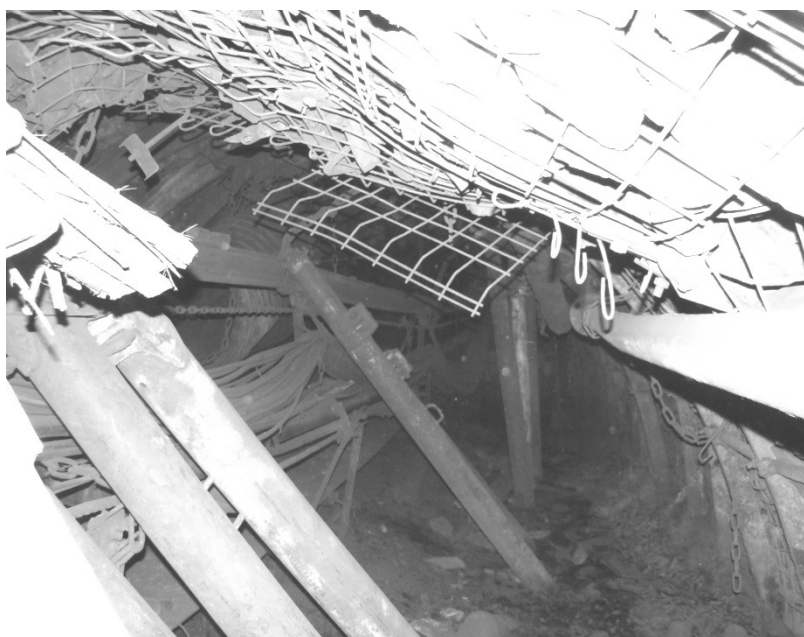
Rys. 33.2 Tąpnięcie w pochylni M-2 w pokładzie 707/2
