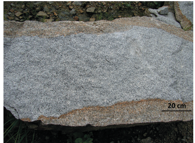
Rys. 4. Widok makroskopowy bryły granitoidu z widocznymi strefami przeobrażonymi Fig. 4. A granitoid block revealing zones of alterations
