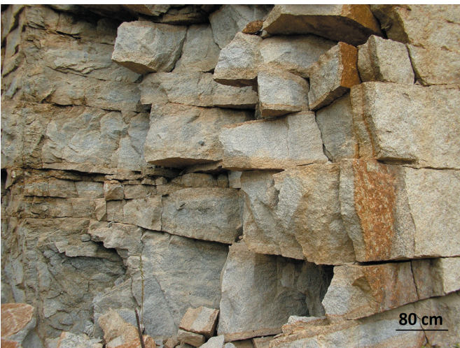
Rys. 3. Pionowe i poziome strefy wietrzeniowe rozwijające się zgodnie z systemem spękań występujących w złożu Fig. 3. Vertical and horizontal weathering zones developed concordantly to the granitoid fracture system
