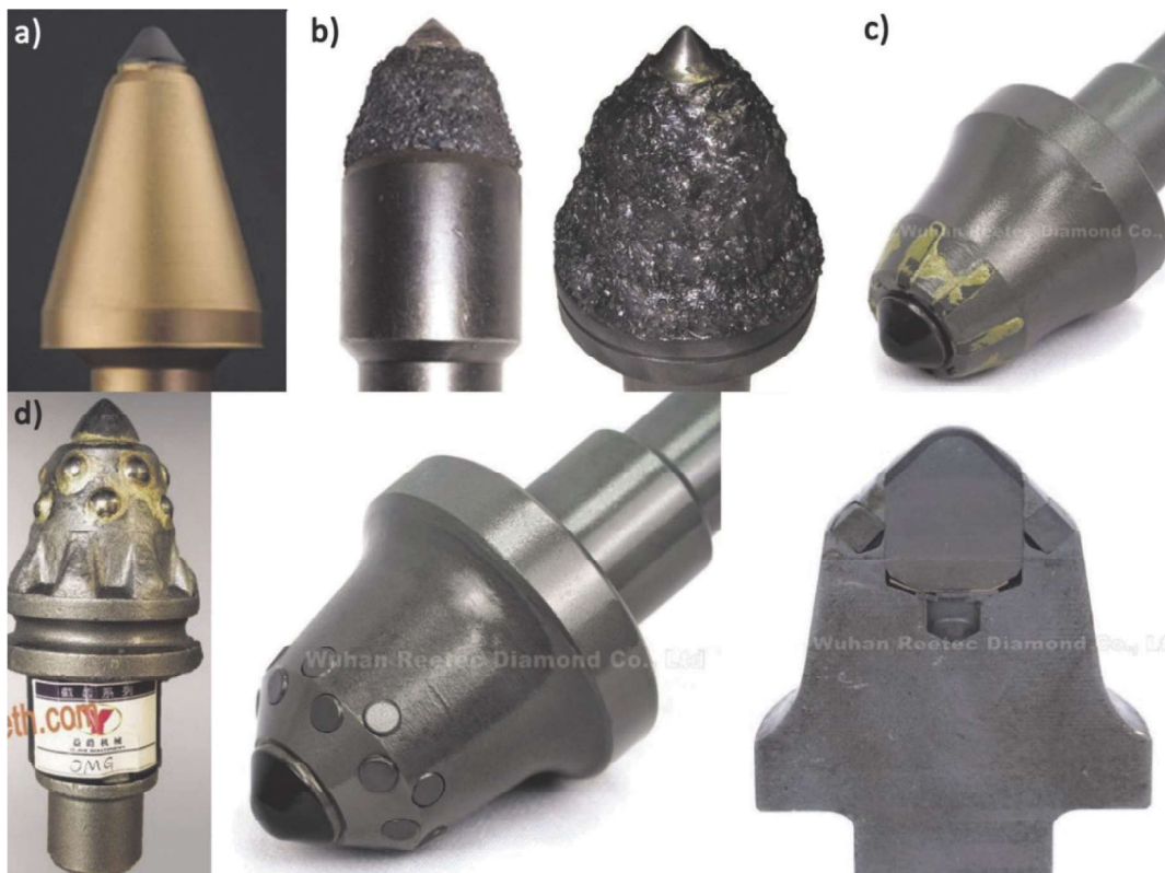
Rys. 4. Inne sposoby zwiększania trwałości noży styczno-obrotowych a) zastosowanie ostrza z PCD, b) zastosowanie unikalnych powłok, c) zastosowanie zbrojenia korpusu płaskimi wkładkami z węglika spiekanego, d) zastosowanie zbrojenia korpusu okrągłymi wkładkami z węglika spiekanego
