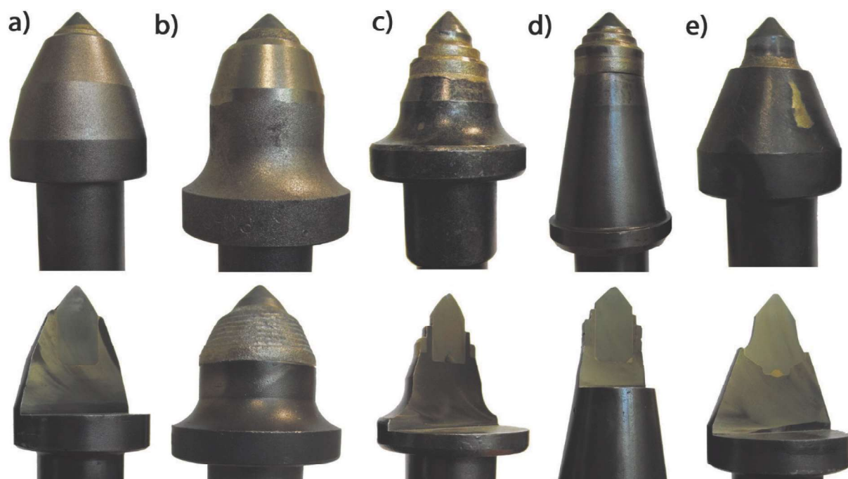
Rys. 3. Sposoby zwiększania trwałości noży a) nóż standardowy, b) noże napawane, c) nóż z pierścieniem z węglika spiekane, d) nóż z dwoma pierścieniami z węglika spiekane, e) nóż z węglikiem typu CAP
