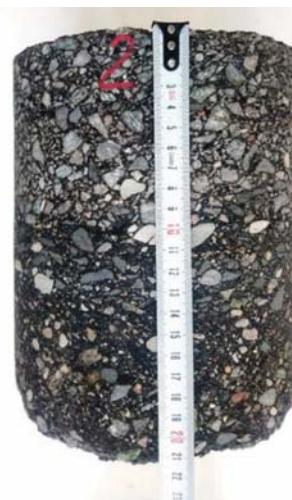
Rys. 4. Porównanie układu i grubości warstw na odcinku od km 16+900 do km 17+600 na prawym pasie ruchu przed remontem drogi krajowej nr 55
