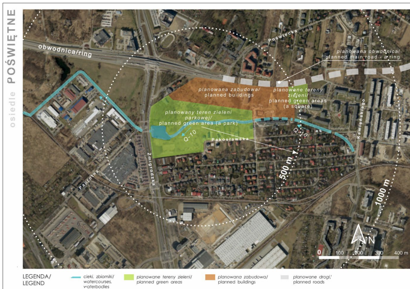
Ryc. 2. Fragment osiedla Polanowice-Poświętne-Ligota. Teren zieleni nieurządzonej wraz z układem elementów wodnych: zbiornikiem o funkcji retencyjnej zbierającym część wód opadowych z ul. Żmigrodzkiej i ciekkiem Q-10 tworzą kanwę do rozwoju zielonej infrastruktury tego fragmentu osiedla. Za negatywne dla ciągłości zielonej sieci należy uznać likwidację pasa zieleni i zarurowanie ciekku na odcinku między ul. Rudawską i Sulejowską oraz wprowadzenie w tym miejscu zabudowy mieszkaniowej
