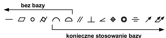
Rys. 1. Symbole tolerancji kształtu, kierunku, położenia oraz bicia zdefiniowane w PN-EN ISO 1101.
