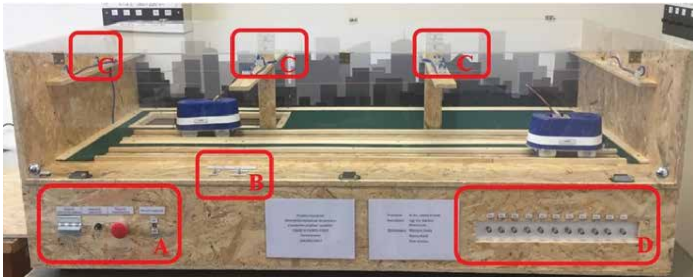
Rys. 2. Widok ogólny zrealizowanej makiety, gdzie: A – panel złączający stanowisko, B – panel sterowania rezystancją dodatkową podstacji, C – odłącznik sieciowy i sekcyny, D – panel wyprowadzeń pomiarowych
