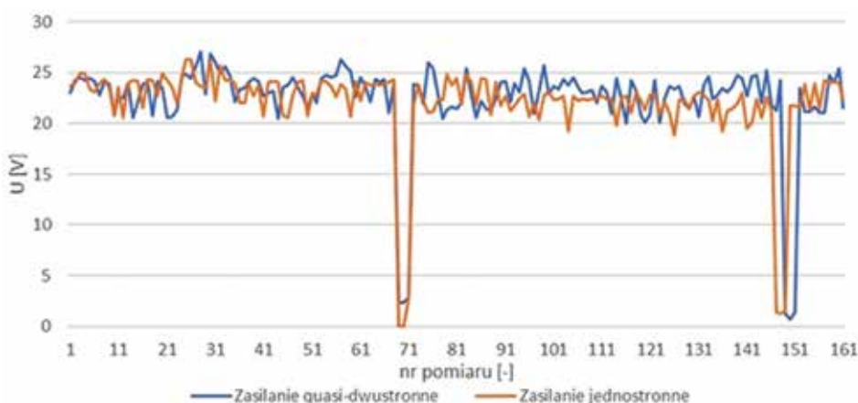
Rys. 6. Napięcie na pantografie dla różnych typów zasilania
