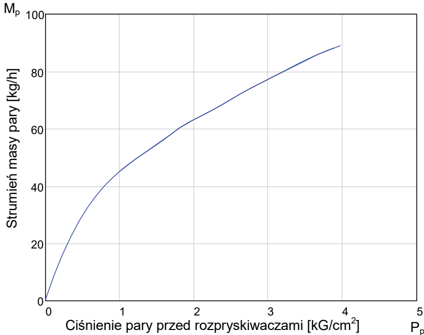
Rys. 2. Zużycie pary dla zmodyfikowanego wtryskiwacza mazutu w zależności od ciśnienia (na 2 wtryskiwacze jednocześnie)
