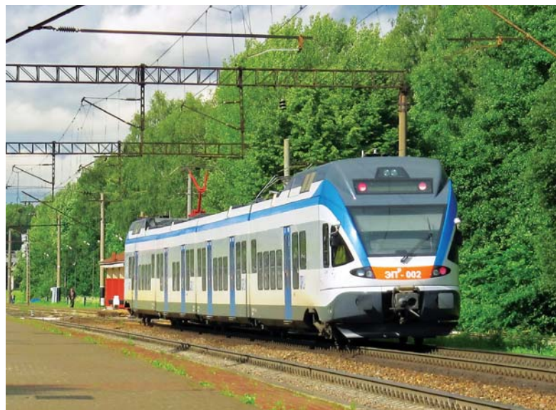
EP R -002 kolei BC (25 kV 50 Hz, 1520 mm) na przedmieściach Mińska, Białoruś (27.06.2012 r.). Fot. O. Kuleczenko
