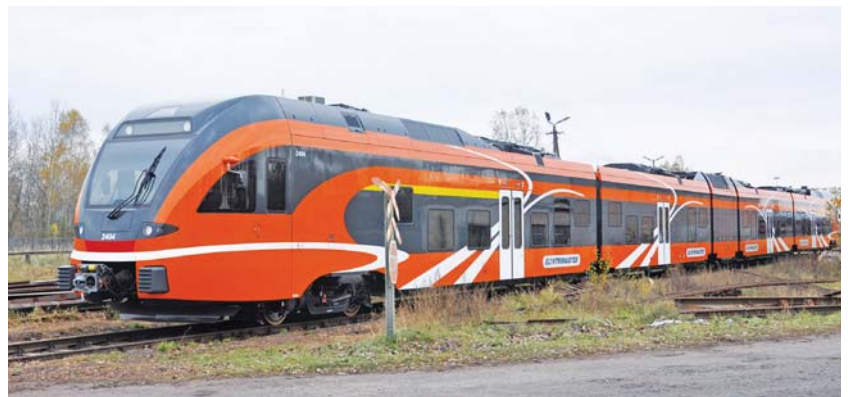
Seria 2404, czyli Flirt z napędem spalinowym dla przewoźnika Elektriraudtee na terenie stacji w Małaszewiczach na torze 1520 mm (3.11.2012 r.). Fot. M. Graff
