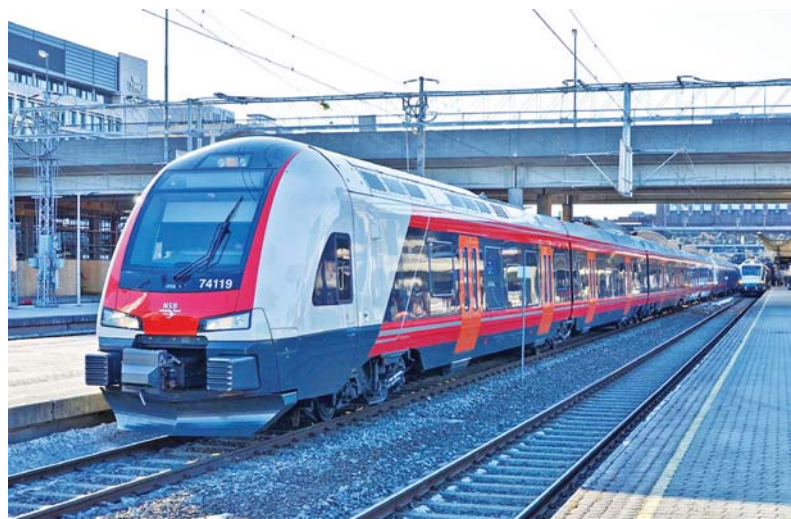
Flirt serii 74119 kolei NSB (15 kV 16,7 Hz) jako pociąg kursujący pomiędzy głównym dworcem i lotniskiem (tzw. Flytoget), Oslo, Norwegia (27.03.2013 r.). Fot. F. Møller
