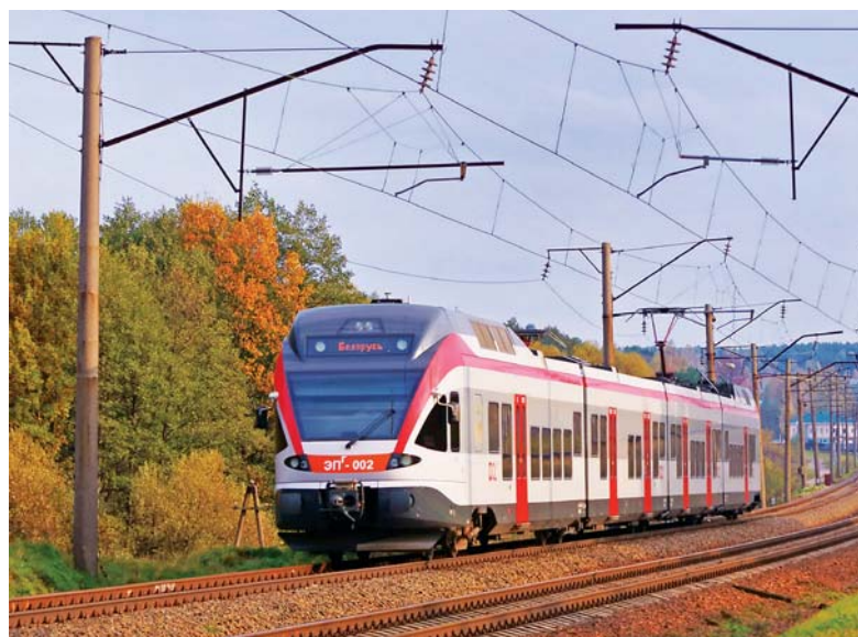
EPG-002 kolei BC (25 kV 50 Hz, 1520 mm) na przedmieściach Mińska, Białoruś (jesień 2013 r.). Fot. S. Badionkin
