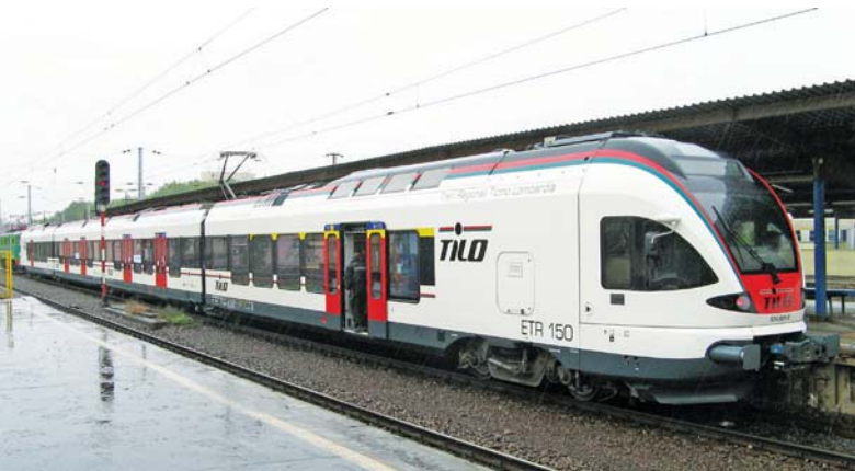
RABe 524.0/ETR 524 (3 kV DC; 15 kV 16,7 Hz), czyli Flirt przewoźnika TILO (Treni Regionali Ticino Lombardia), na dworcu Warszawa Wschodnia (5.09.2007 r.). Fot. M. Graff
