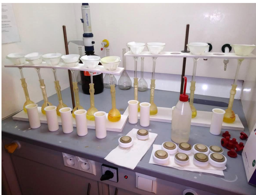
Fot. 1. Sączenie próbek po mineralizacji Photo 1. Straining the samples after mineralisation
