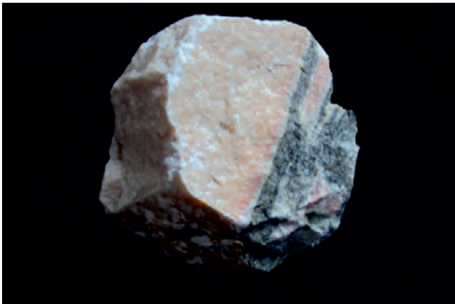
Rys. 7. Marmur różowy, drobnokrystaliczny z przewarstwieniami szarozielonymi
