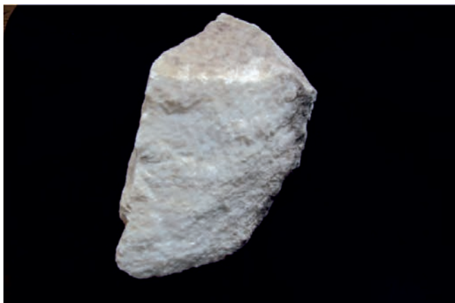
Rys. 8. Marmur biało-szary, drobnokrystaliczny z przewarstwieniami szarozielonymi z kamieniołomu wschodniego
