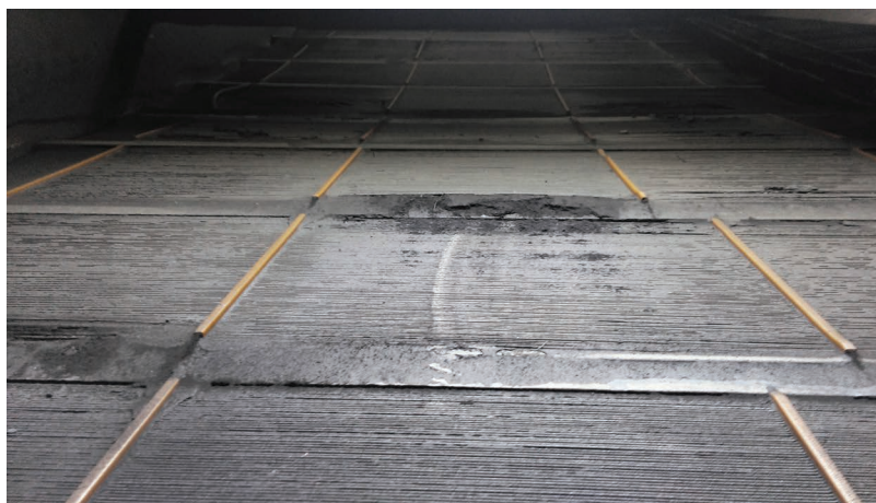
Wykorzystanie sit strunowych do „odmulniania na sucho”
