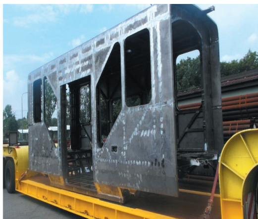
Rys. 5. Konstrukcja członu środkowego tramwaju [3]
