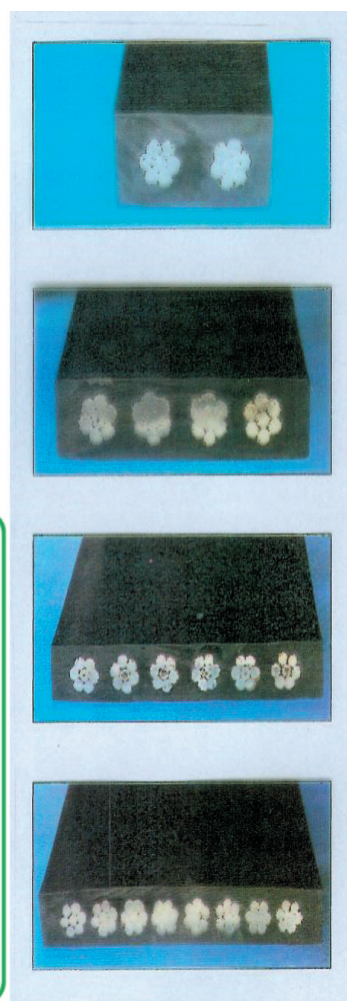
Rys. 1. Budowa liny wyrównawczej płaskiej stalowo-gumowej SAG [2]
