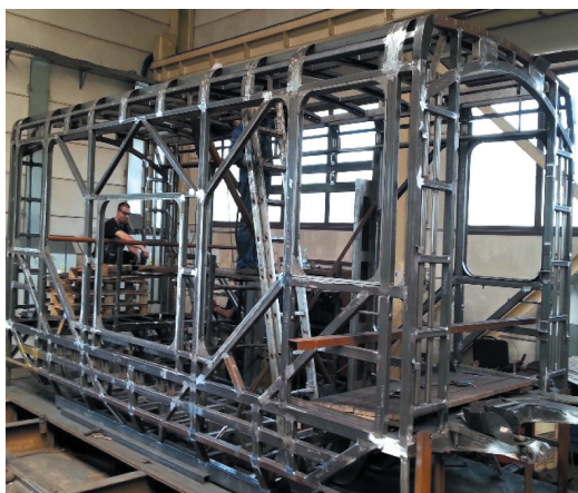
Rys. 5. Konstrukcja członu środkowego tramwaju [3]
