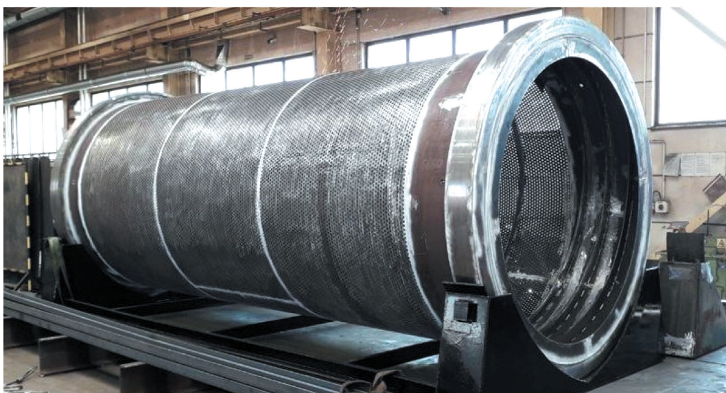
Rys. 6. Konstrukcja przesiewacza bębnowego [3]
