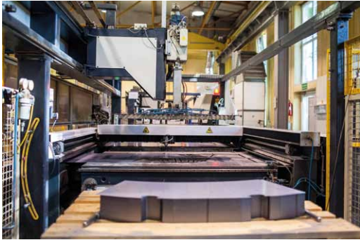
Rys. 4. Stanowisko do cięcia blach magnetycznych za pomocą laserów
