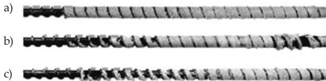
Rys. 2. Wpływ dozowanego zasilania na wypełnienie ślimaka w procesie wytłaczania kompozytu WF/PP_50/50, z prędkością obrotową ślimaka N = 80 obr/min: a) G = 22,15 kg/h, G/N = 0,277 , b) G = 20,67 kg/h, G/N = 0,258 , c) G = 19,55 kg/h, G/N = 0,244
