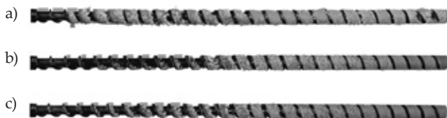
Rys. 3. Wpływ dozowanego zasilania na wypełnienie ślimaka w procesie wytłaczania kompozytu WF/PP_25/75, z prędkością obrotową ślimaka N = 80 obr/min: a) G = 21,93 kg/h, G/N = 0,274 , b) G = 20,41 kg/h, G/N = 0,255 , c) G = 19,23 kg/h, G/N = 0,240
