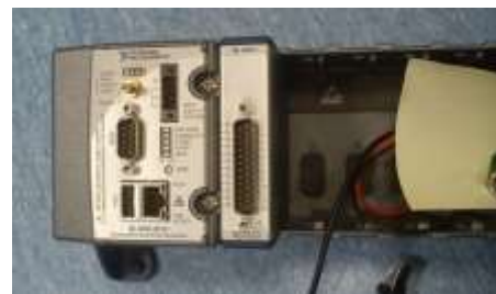
Rys. 3. Kontroler NI cRIO 9014 z kartą cyfrowych wejść/wyjść NI 9401
