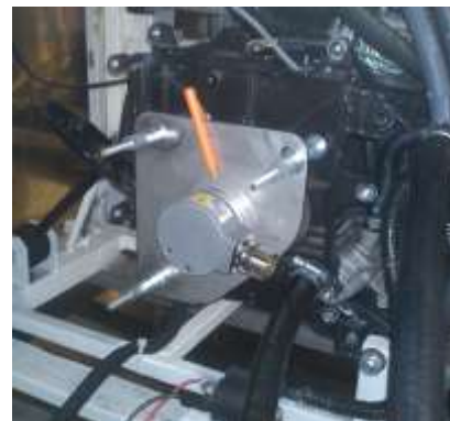
Rys. 2. Enkoder Kubler Sendix 8.5835.1274.G423 zamontowany na czopie wału korbowego silnika spalinowego.
