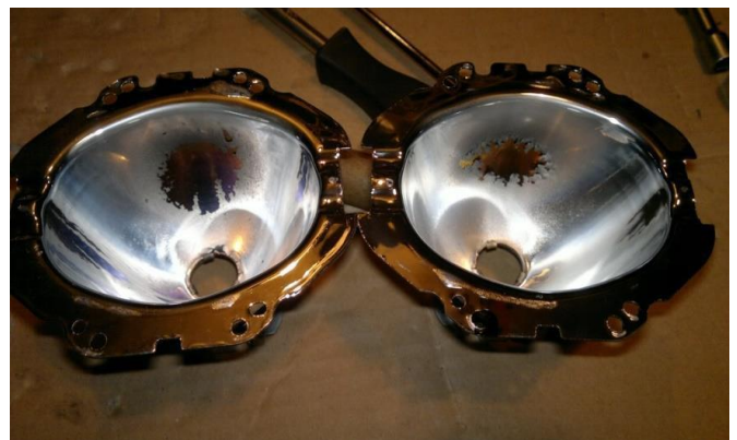
Rys. 4. Przykładowe uszkodzenie odbłyśników [8]
