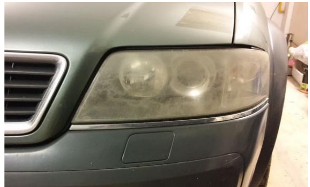
Rys. 3. Przykład zużytego klosza reflektora [6]
