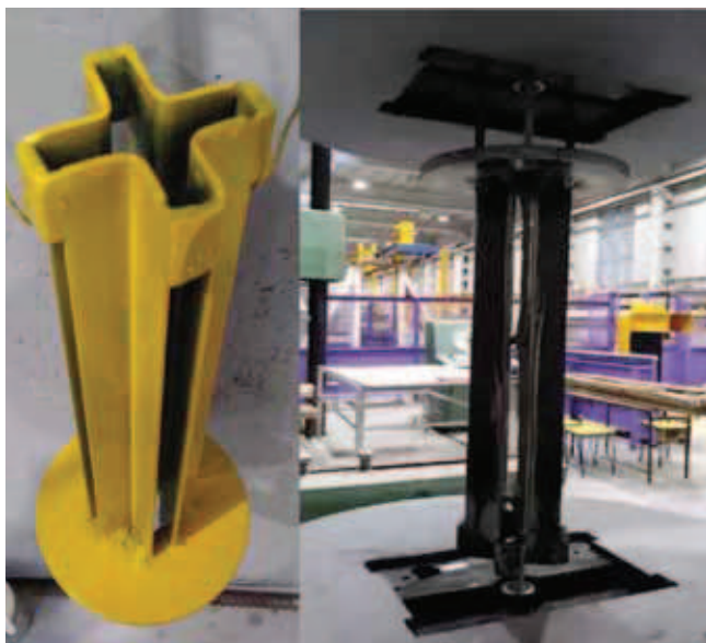
Rys. 7. Po lewej – szczęki po pomalowaniu na żółto, po prawej – pręt zamocowany w szczękach w maszynie wytrzymałościowej przed pomalowaniem szczęk
