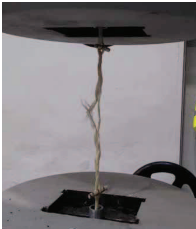
Rys. 4. Pręt poddany rozciąganiu po zerwaniu
