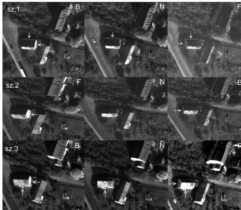
Rys. 4. Zasięgu pomiaru przyziemia dowolnego budynku w pasie potrójnego pokrycia: szereg 1, 2, 3, F – widok do przodu, N – widok w nadirze, B – widok do tyłu
