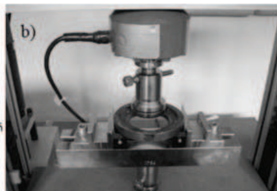
Rys. 5. Warunki przeprowadzania badania wytrzymałościowego: a) schemat, b) widok stanowiska (bez założonej próbki)
