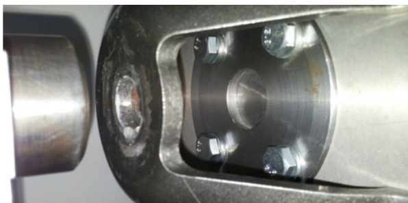
Rys. 3. Sposób mocowania próbki w badaniach perforacji stali Armox® 500T w warunkach dynamicznych
