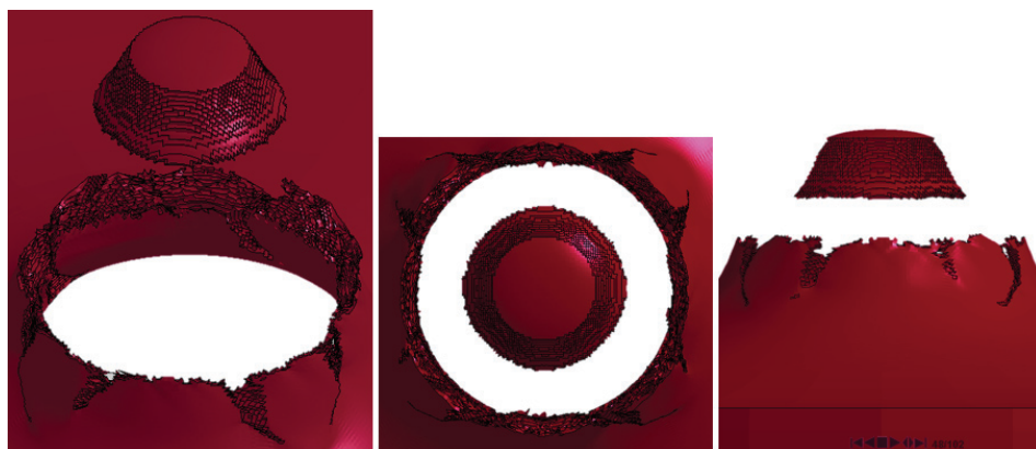
Rys. 13. Postać zniszczenia próbki w procesie perforacji penetratorem kulistym w warunkach dynamicznych
