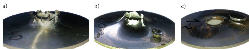
Rys. 8. Przykładowe zdjęcia próbek po badaniach perforacji cienkich płytek w warunkach dynamicznych przez penetrator: a) ostry, b) kulisty, c) walcowy
