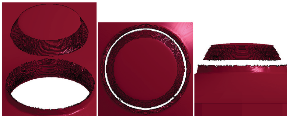
Rys. 15. Postać zniszczenia próbki w procesie perforacji penetratorem walcowym w warunkach dynamicznych
