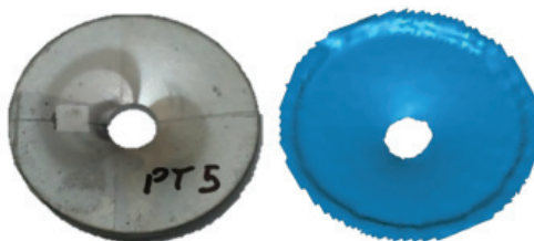
Rys. 6. Próбка oraz jej skan po przeprowadzonych badaniach perforacji płytek
