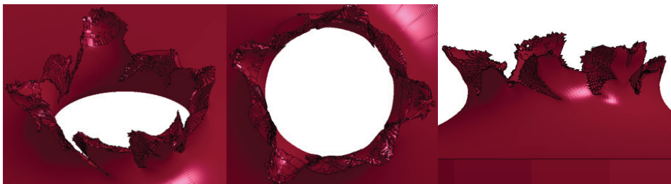
Rys. 11. Postać zniszczenia próbki w procesie perforacji penetratorem ostrym w warunkach dynamicznych
