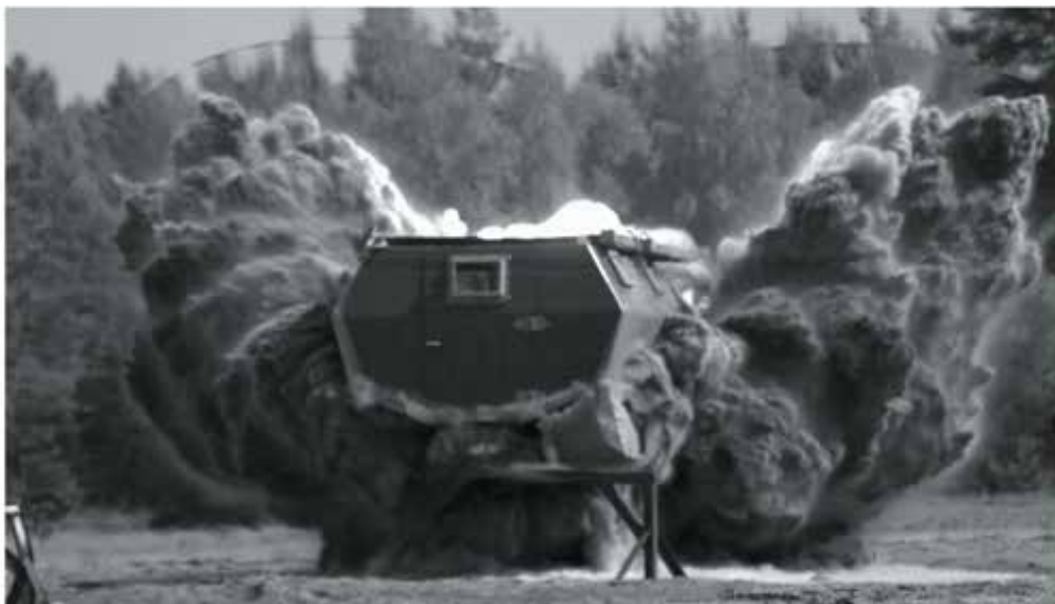
Rys. 13. Badanie odporności pojazdu GermaZ G10 i bezpieczeństwa pasażerów w testach poligonowych
