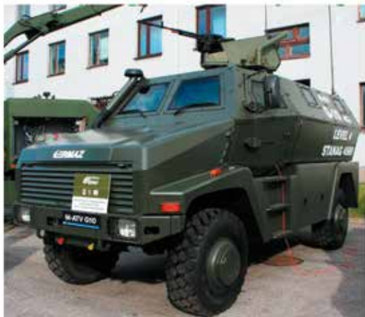
Rys. 12. Opancerzony pojazd GermaZ G-10 o zwiększonej odporności na eksplozje min (po lewej) i prototyp fotela tłumiącego energię wybuchu (po prawej)
