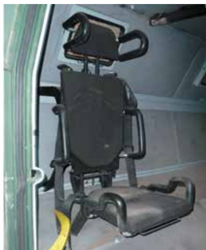
Rys. 12. Opancerzony pojazd GermaZ G-10 o zwiększonej odporności na eksplozje min (po lewej) i prototyp fotela tłumiącego energię wybuchu (po prawej)
