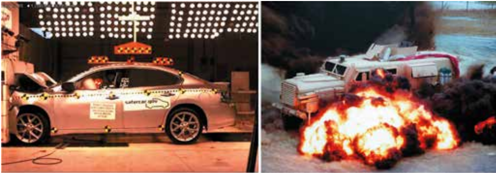
Rys. 1. Test zderzeniowy samochodu osobowego (z lewej), test eksplozji pod pojazdem opancerzonym (z prawej)
