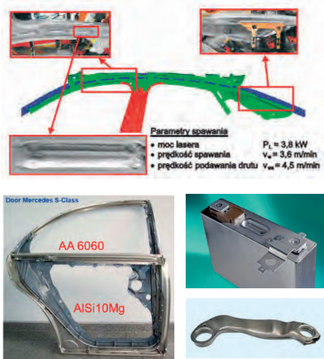
Rys. 2. Przykładowe wykorzystanie spawania laserowego i hybrydowego w przemyśle motoryzacyjnym do łączenia elementów konstrukcyjnych z aluminium: a) konstrukcja dachu spawana z wykorzystaniem metody laser+ MIG w sam. Audi A8, b) elementy drzwi, c) elementy baterii, d) element osi Mercedesa S-Class (Daimler) [9 – 12]
