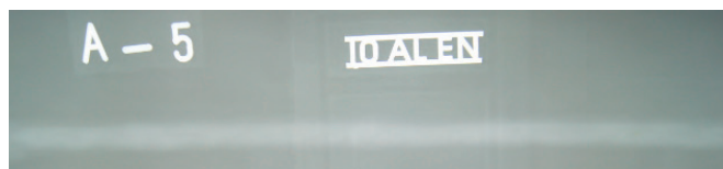
Rys. 6. Radiogram złącza doczołowego 5 + 5 mm wykonanego metodą HLAW
