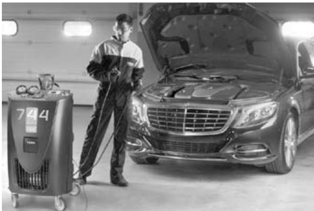
Rys. 2. Środki ochrony indywidualnej podczas prac z układem klimatyzacji
