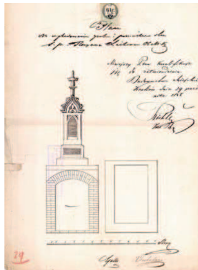
Ryc. 6. Projekt grobu Floryana Leihera z 1858 roku autorstwa Gallego ukazujący formę pomnika nagrobnego, jak również typowe w tym czasie kolebkowe (łukowe) sklepienie wykonanej z cegły piwnicy grobowcowej Fig. 6. Project of Floryan Leihera's grave from 1858, designed by Galli, showing the form of a tombstone and a barrel (arch) vault of the tomb cellar made from brick, typical for the time
