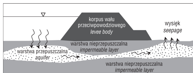
Ryc. 1. Schemat powstawania przebiecia hydraulicznego (Ozkan, 2003, zmienione)
