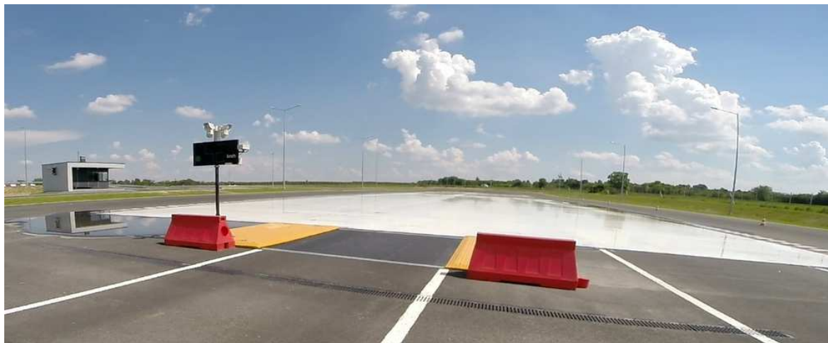
Rys. 6. „Płyta poślizgowa prostokątna” (obszar o jasnym kolorze) wraz z „płytą dynamiczną” (czarny czworokąt) produkcji krajowej – firmy UNIMETAL ze Złotowa [29]
